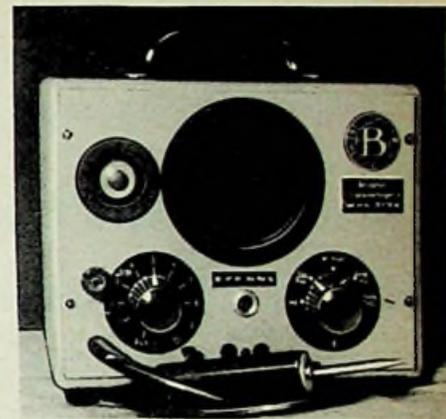
Bild 2. Gerät und Tastkopf des Bellophon-Signalverfolgers
